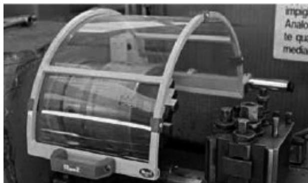
Skärm i polykarbonat med stålram och mikrobrytare.
