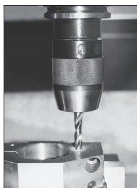
1. Borra kylpassagen och lämna mått för brotschning
