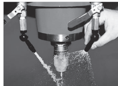
2. MillJet visas monterad på en vertikal fleroperationsmaskin- en vid stråle och en smal.
