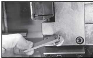
Korta förlängare justeras med verktyg.
