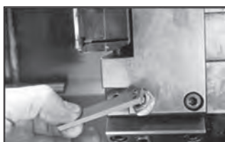
Korta förlängare justeras med verktyg
