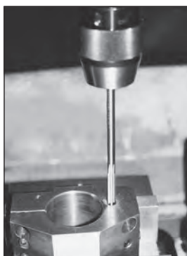
2. Brotscha hålet till nominell storlek -0 +0,05 mm.
