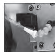
TYP 2. OddBall monterad med 1/4" Snap-Loc
