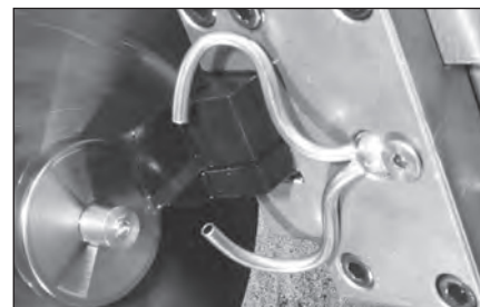
TwinPop munstycke monterat på svarv.
