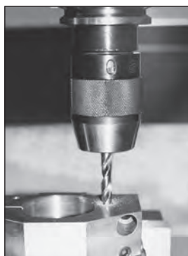
1. Borra kylpassagen och lämna mått för brotschning
