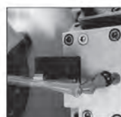
TYP 1. OddBall monterad med 1/4" Loc-Line
