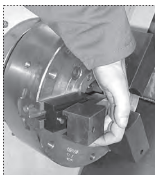
Sätt den nya backen över laxspåret och tryck ner backen över låspinnen.
