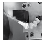
TYP 2. OddBall monterad med 1/4" Snap-Loc
