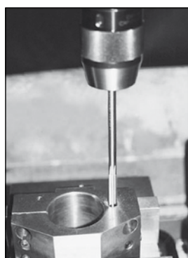
2. Brotscha hålet till nominell storlek -0 +0,05 mm.
