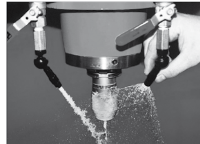
2. MillJet visas monterad på en vertikal flerooperationsmaskin- en vid stråle och en smal
