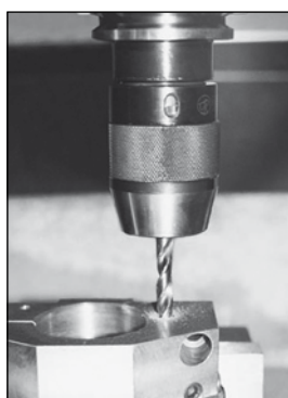
1. Borra kylpassagen och lämna mått för brotskning
