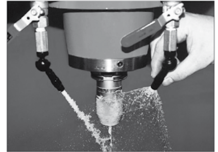
2. MillJet visas monterad på en vertikal flerooperationsmaskin- en vid stråle och en smal
