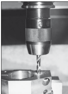
1. Borra kylpassagen och lämna mått för brotschning
