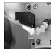
TYP 2. OddBall monterad med 1/4" Snap-Loc
